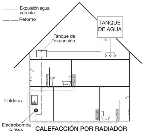
Este producto está fabricado en Argentina con la más alta calidad y tecnología que ofrece un óptimo rendimiento con un menor consumo de energía eléctrica. Se emplean generalmente para la recirculación de agua en un circuito de calefacción, intercambiadores de calor, refrigeración y circuitos cerrados sin renovación de agua permanente.
